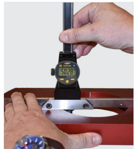
Messung einer Höhe mit Messbrücke
