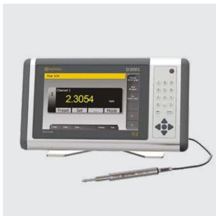
Messtaster P12D USB mit D300S. (maximale Auflösung 0.1µm)
