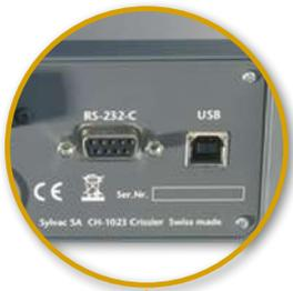
Kabelanschluss für USB auf USB (804-1210) oder Kabelanschluss für RS232 auf RS232 (925-5609)
