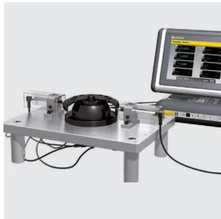
Gleichzeitige Mehrkanal-Anzeige mit Einheit D200S auf einer Mehrstellenmessvorrichtung
