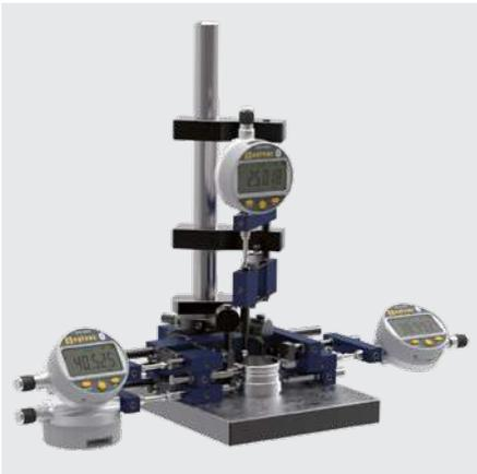
Messuhren mit Bluetooth® Technologie auf einem 4 Punkte Werkstückträger
