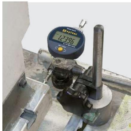
Vertikale Wegmessung eines Elementes
