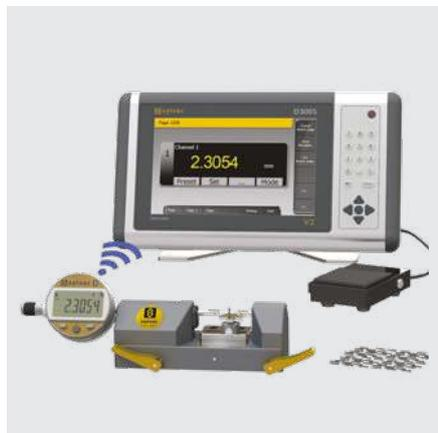
Messbank verbunden durch Bluetooth®-Funktechnologie und Pedal über USB angeschlossen.
