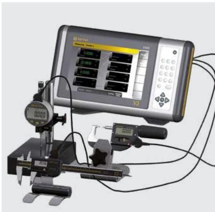
Vielfältige Verbindung von Handmessgeräten mit Toleranzanzeige
