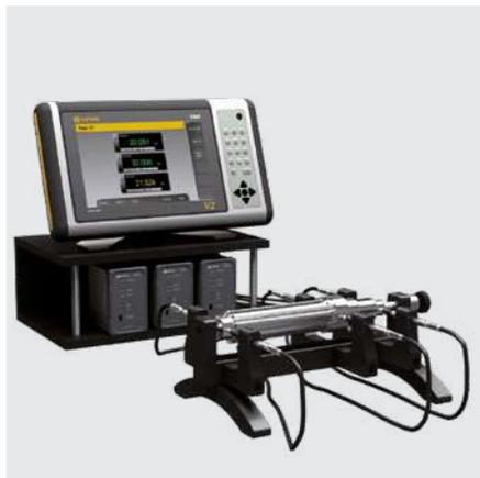
Messtaster Anschluss auf einem D300S über D302 Multiplex-Einheit.
