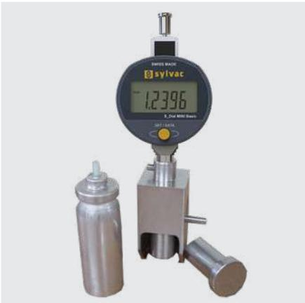
Innendurchmesserprüfung mit mechanischem Messkopf
