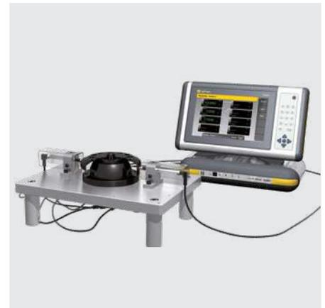
Kapazitive Messtaster auf einem Werkstückträger
