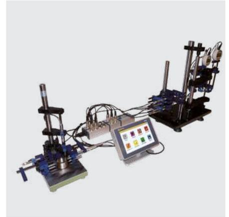
Messtaster und Instrumenten Anschlüssen über M-BUS-Anschluss
