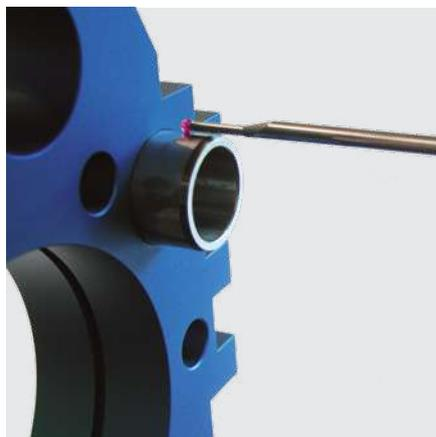
Messung eines Aussen-Ø mit Standardmesseinsatz 930-2101
