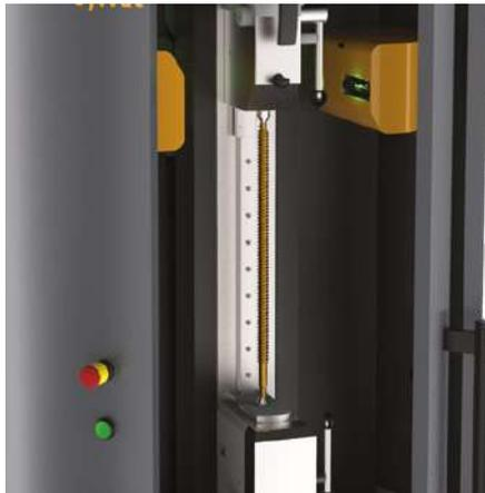
Messung eines Teiles mit Sylvac Scan F60L
