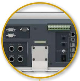
Kabelanschluss für USB auf USB (804-1210) und Kabelanschluss für RS232 auf RS232 (925-5609)
