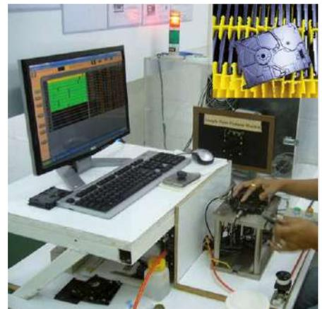
Mehrstellenmessvorrichtung zum Prüfen von Festplattenträger
