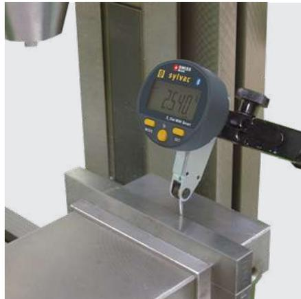
Überprüfung der Ausrichtung eines Fräsmaschinenschraubstocks
