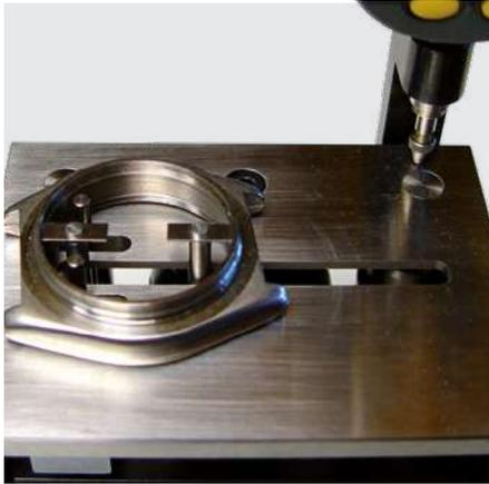
2-Punkt Innenmessung mit Selbstzentrierung auf VLS 50
