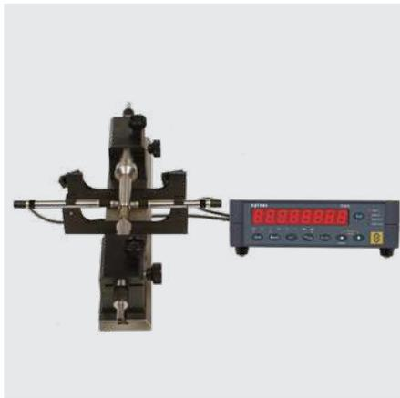
Messen eines Aussendurchmessers einer Achse
