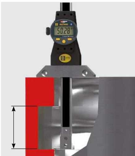
Messung einer Nutenhöhe in einer Bohrung mittels Messeinsatz mit Stift Ø4 Nr 805-6103 (Automatische Referenz)
