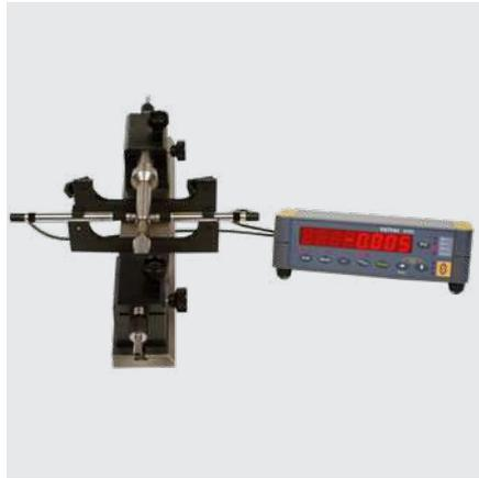
Messen eines Aussendurchmessers einer Achse mit P5 und D50S
