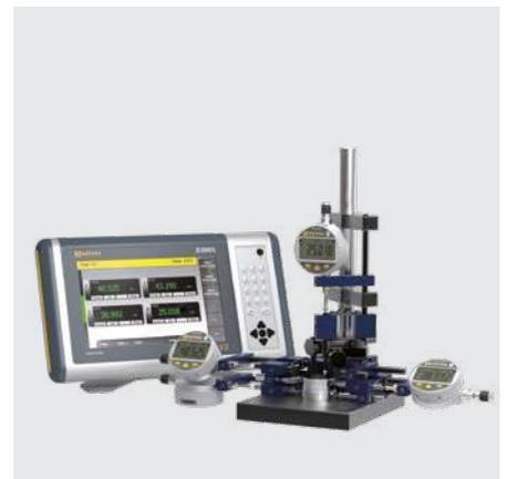
Messuhren mit Bluetooth® Technologie Anschluss auf D300S.
