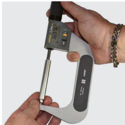
Messung Länge eines Schneidteil
