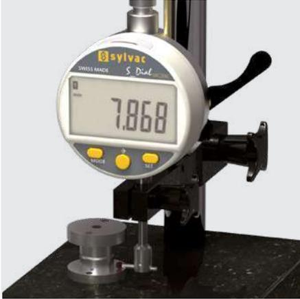
Messen eines Ansatzes mit S\_Dial WORK und Kugel-Messeinsatz Typ 905-2207
