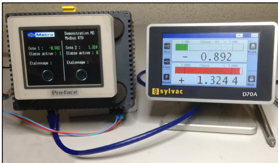
Exemple de communication modbus RTU avec un automate Pro-face
