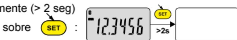
En modo hibernación el sensor conserva el valor original (modo SIS) y el equipo se reanuda automáticamente por un movimiento de la tecla de medición por control RS, o pulse un botón.
