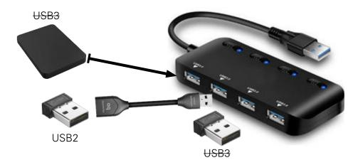
Le bruit généré par le spectre de données de l'USB 3.0 peut avoir un impact sur les récepteurs radio dont l'antenne est placée à proximité d'un dispositif USB 3.0 et/ou d'un connecteur USB 3.0, il faut donc éviter les connexions côte à côte.
