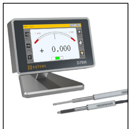
Palpeurs Heidenhain connectés à une D70H
