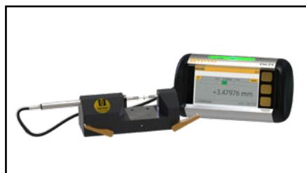
Mit einer D62S verbundene, an einen P12D-Taster gekoppelte Messbank PS15.
