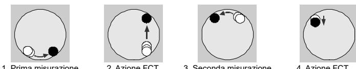
Alla fine della misurazione (4) il pulsante FCT rilascia la sonda per consentire una nuova misurazione del diametro.
