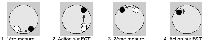
A la fin de la mesure (4) le bouton FCT dégage la touche de mesure pour permettre une nouvelle mesure de diamètre.
