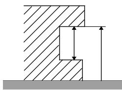
Mit der UP/DOWN-Taste hinten am Instrument den motorisierten Schlitten verschieben, bis die Messtaste die Ständeroberfläche (Marmor) berührt. SET Taste drücken um die Anzeige auf Null oder den gespeicherten Vorwahlwert zu setzen. Messtaster mit Hilfe der Steuertasten auf die nächste Messposition bringen.
