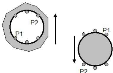
1. Desplace el carro motorizado hasta que el botón de medición se encuentre en el punto P1, separado en relación al eje del diámetro (o del árbol) que se va a medir
