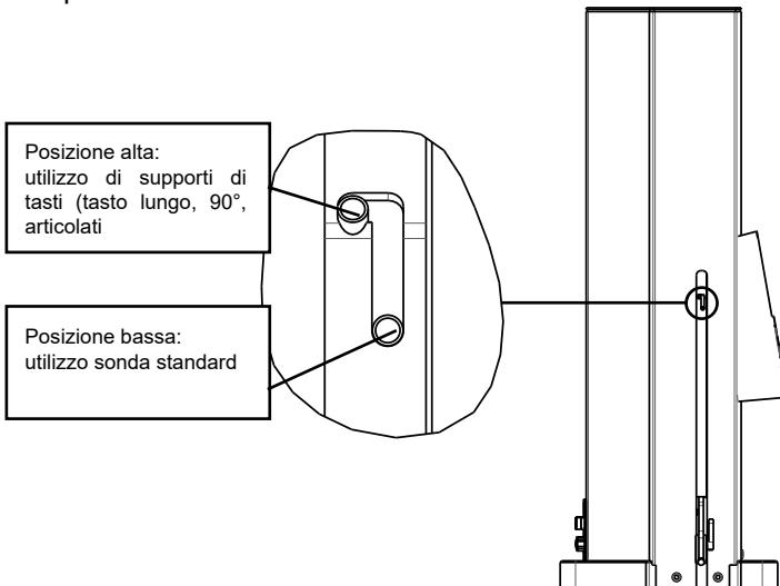
La regolazione della posizione del selettore può avvenire mediante un cacciavite 00 o una penna a sfera.
