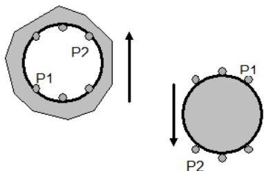
1. Messtaster in die Bohrung oder auf einer Seite der zu messenden Welle einführen. In einem Punkt P1, der versetzt zum Scheitelpunkt liegt, abtasten.
