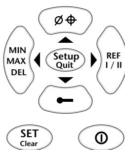
El botón SETUP permite acceder al sistema de menús para modificar los parámetros y las funciones adicionales del Hi\_Cal.
