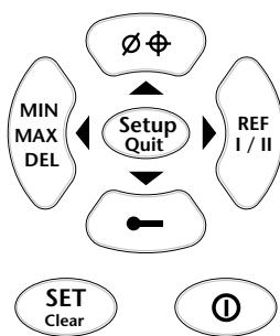
Le bouton SETUP permet d'accéder au système de menus, afin de modifier les paramètres et fonctions étendues du Hi\_Cal.
