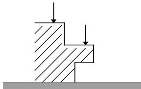
Utilizzare il pulsante UP/DOWN sul retro dello strumento per spostare il carrello motorizzato, fino a quando la sonda va a contatto con la superficie di base (marmo). Premere il pulsante SET per azzerare (o riportare al valore predefinito) la visualizzazione sulla posizione del riferimento.
