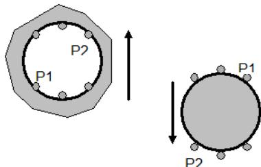
1. Spostare il carrello motorizzato, fino a quando la sonda si trova a un punto P1, diminuito rispetto all'asse del diametro (o dell'albero) da misurare
