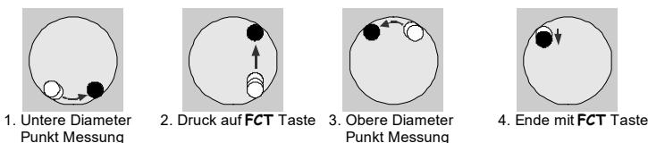
Nach Beenden der Messung (4) bewirkt das Betätigen der FCT Taste ein Abheben des Messtasters, eine neue Durchmessermessung kann vorgenommen werden.
