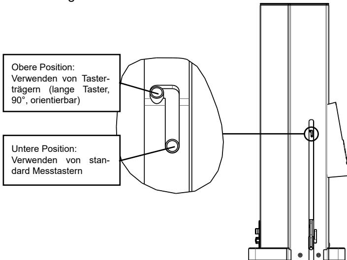
Das Verstellen des Hebels kann mit Hilfe eines Schraubenziehers 00 oder einer Kugelschreberspitze durchgeführt werden.
