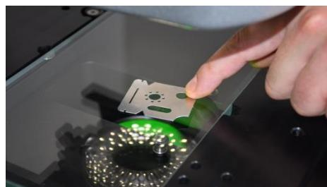
**6** Déplacer l'axe Z afin d'obtenir une image nette et ajuster les sources lumineuses pour une détection optimale des arrêtes.
